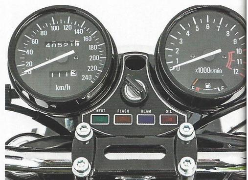
Der komplett revidierte 1100er-Motor wartet nun mit dem ersten Übermaß auf und drückt wohl noch immer seine knapp 110 PS der offenen Version. Tacho und Drehzahlmesser (o.) stammen wie einige andere Teile von einer Zephyr 750, wurden im Z1-Stil umgebaut und sauber ins Cockpit integriert. Der Auspuff von Speed Products (r.) macht äußerlich auf Brüllrohr, hat aber eine ABE. Die Bremspumpe hinten stammt von einer Suzuki GSX-R
