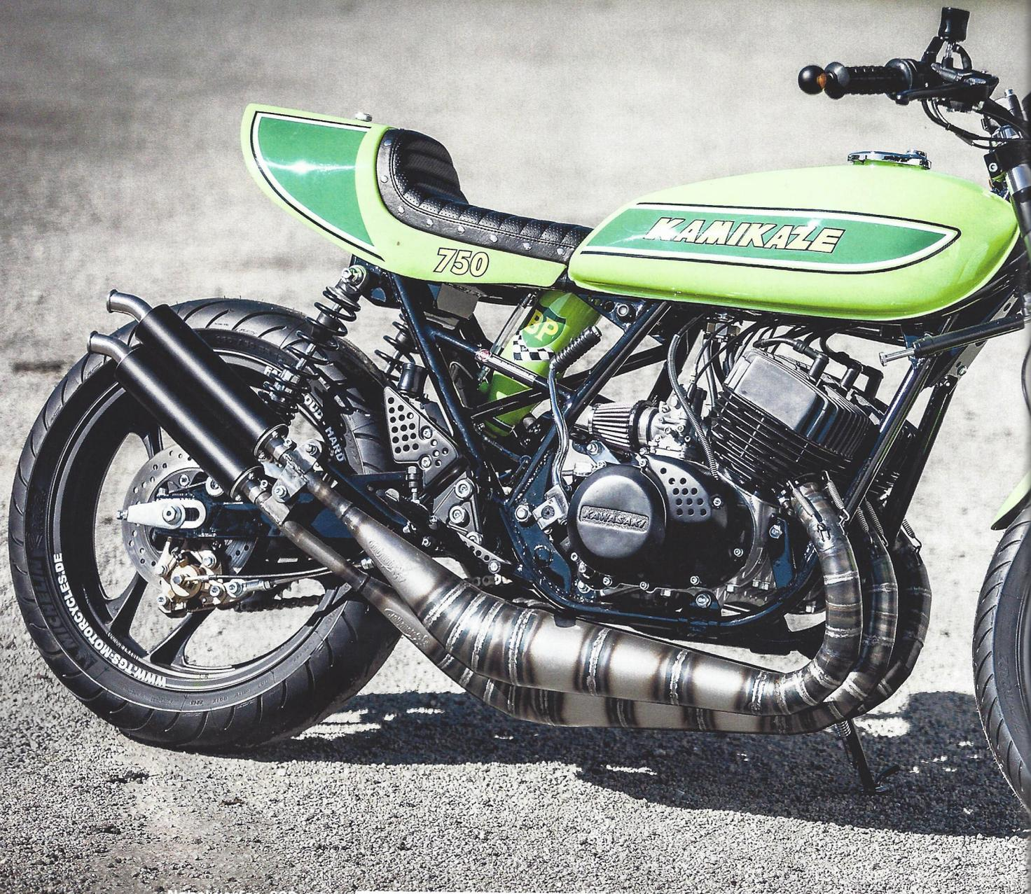
Nebelwerfer, 800-ccm-Kolben und 34er-Vergaser verhelfen dem kompakten Dreizylinder zu mehr als 100 PS
