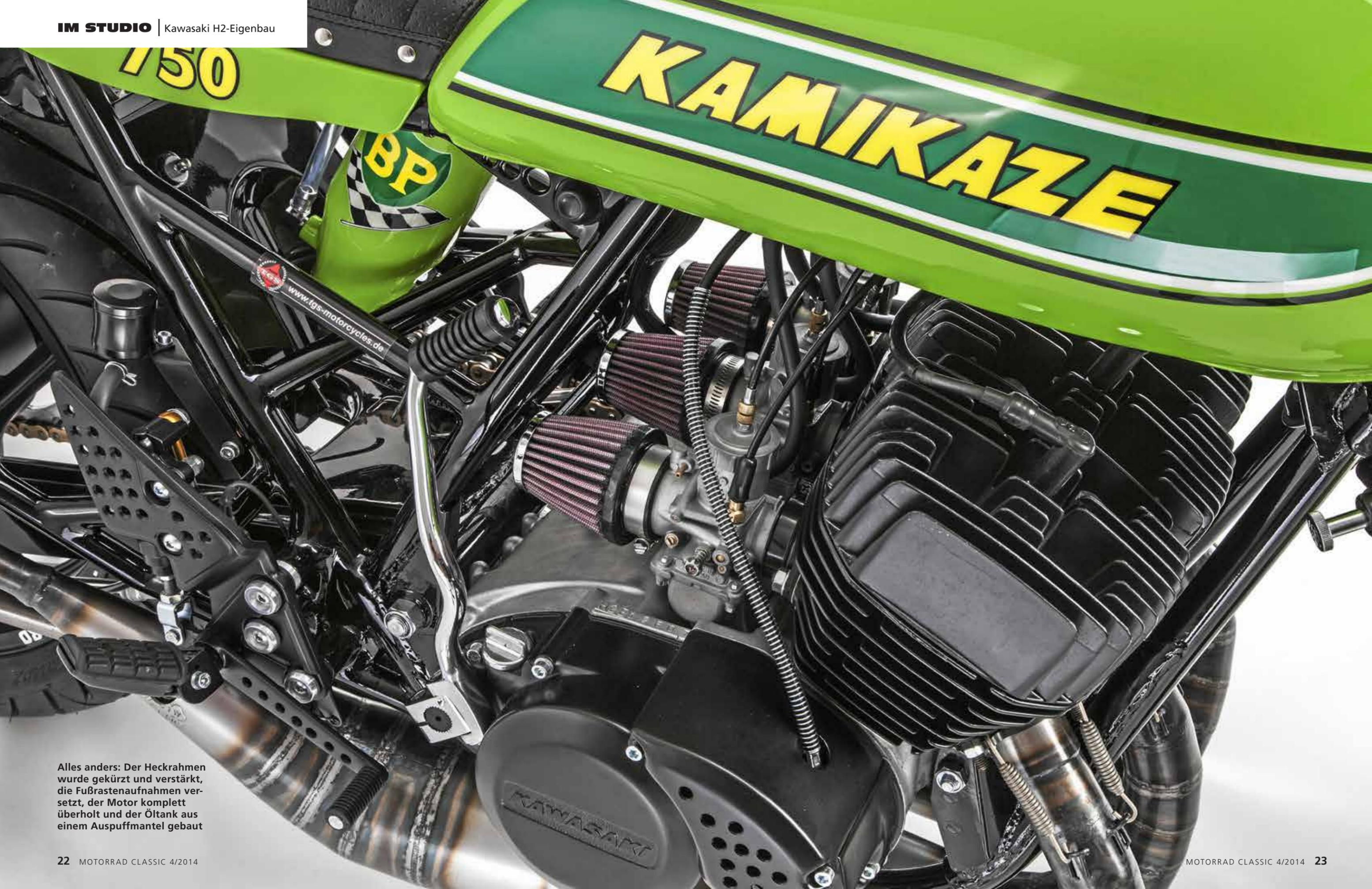
Alles anders: Der Heckrahmen wurde gekürzt und verstärkt, die Fußrastenaufnahmen versetzt, der Motor komplett überholt und der Öltank aus einem Auspuffmantel gebaut
