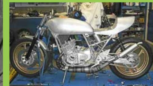
Zwischenschritt: Die „Kamikaze“ mit geändertem Rahmen und speziellem Höcker
