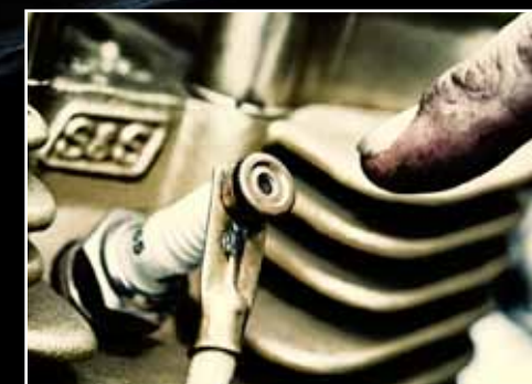
"Kom daar niet aan!": de open liggende bougiekabel 'vervent' je met 20.000 Volt bij aanraken.
