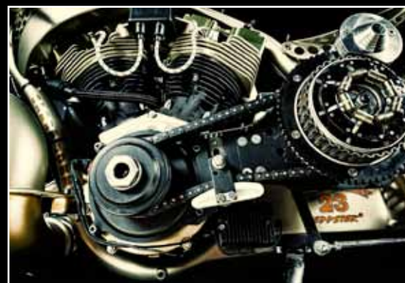
"Kom daar niet aan!": de open primaire aandrijving middels ketting met span-mechanisme.
