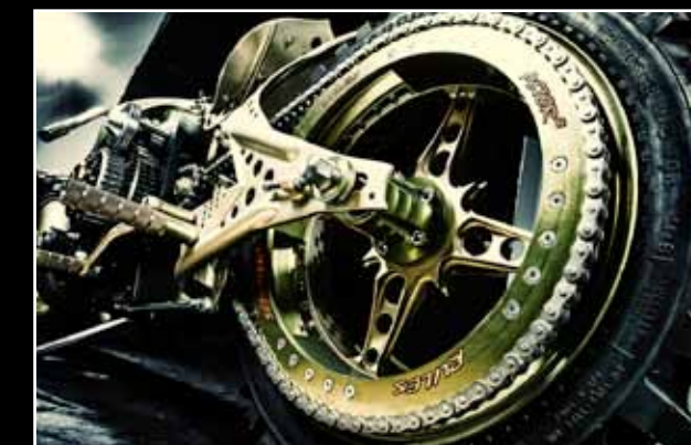
"Kom daar niet aan!": twee prachtige, reusachtige tandwielen van de secundaire aandrijving.
