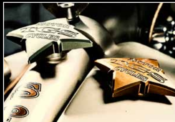
"Daar mag je wél aankomen!": de centrale buis van het frame dient als oliereservoir voor de dry-sump smering, rechts de brandstoftank.
