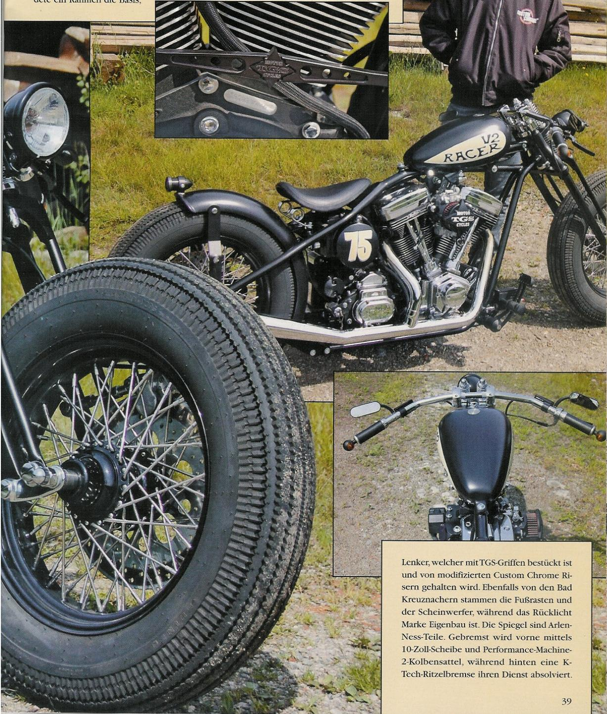
Lenker, welcher mit TGS-Griffen bestückt ist und von modifizierten Custom Chrome Risern gehalten wird. Ebenfalls von den Bad Kreuzachern stammen die Fußrasten und der Scheinwerfer, während das Rücklicht Marke Eigenbau ist. Die Spiegel sind Arlenness-Teile. Gebremst wird vorne mittels 10-Zoll-Scheibe und Performance-Machine-2-Kolbensattel, während hinten eine K-Tech-Ritzelbremse ihren Dienst absolviert.
