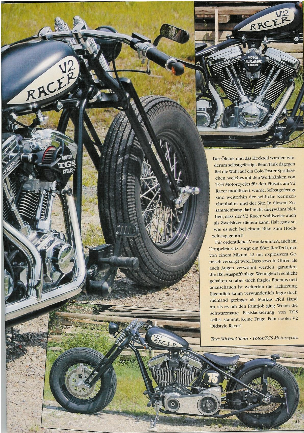
Der Öltank und das Heckteil wurden wiederum selbstgefertigt. Beim Tank dagegen fiel die Wahl auf ein Cole-Foster-Spritifäßchen, welches auf den Werkbänken von TGS Motorcycles für den Einsatz am V2 Racer modifiziert wurde. Selbstgefertigt sind weiterhin der seitliche Kennzeichenhalter und der Sitz. In diesem Zusammenhang darf nicht unerwähnt bleiben, dass der V2 Racer wahlweise auch als Zweisitzer dienen kann. Halt ganz so, wie es sich bei einem Bike zum Hochzeitstag gehört!
