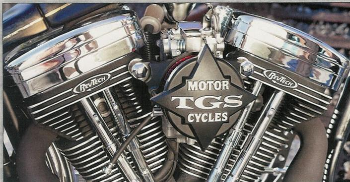
▲ Evo-Style: Der 88 cui-Motor von Rev Tech mit TGS-Filter
